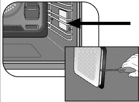
3. Повдигнете защитния стъкллен капак на лампата с отвертка.
