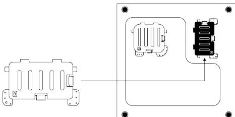
Fixați agățătoarele Capacului B în panoul inferior Finalizați asamblarea prin rotirea capacului.
