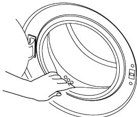
După fiecare spălare, asigurați-vă că în produs nu au rămas substanțe străine. Dacă orificiile din burduful ușii prezentate în imagine sunt înfundate, eliberați-le folosind o scobitoare.
