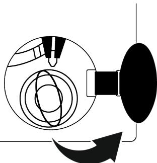
3. Trageți în jos cu o unealtă mânerul de urgență al ușii de încărcare, și eliberați. Apoi, deschideți, ușa de încărcare.
