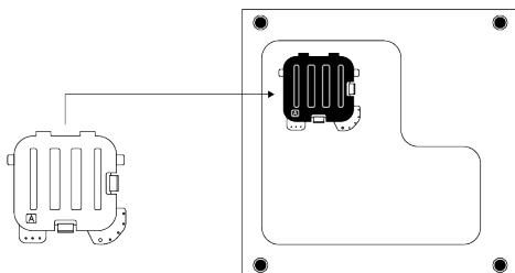
Înclinați mașina ușor pe spate. Fixați agățătoarele Capacului A în panoul inferior. Finalizați asamblarea prin rotirea capacului.
