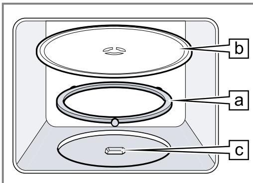
2. Фиксирайте въртящата се чиния **b** в задвижването **c** в средата на дъното на камерата.
