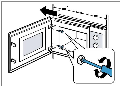
4. Proverite odstojanje prema susednim uređajima.
