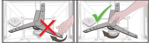
**i** Не се опитвайте да въртите перките за впръскване на вода като държите краищата им. Опитът да завъртите крайните части може да доведе до счупване на зъбните колела в перките за впръскване на вода.
