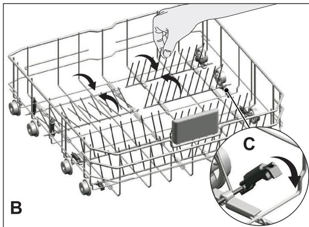
**i** Свалянето на зъбците в хоризонтално положение, държейки ги за краищата, може да ги огъне. Правилният метод е, да свалите зъбците до средна позиция между вертикално и хоризонтално положение, като ги хванете в долния край и след това ги натиснете по посока на стрелката.
