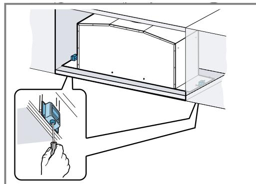
3. Ataşați cadrul și fixați-l cu șuruburi în partea inferioară a aparatului.
