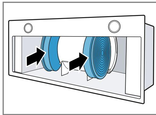
4. Montațifiltrelepentru grăsimi.
