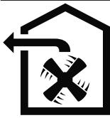
Aerul nu trebuie să fie evacuat printr-un coș care este utilizat pentru evacuarea gazelor arse de la aparete, gazului sau altor carburanți (nu se aplică pentru aparatel la care se utilizează tehnologia de recirculare a aerului).
