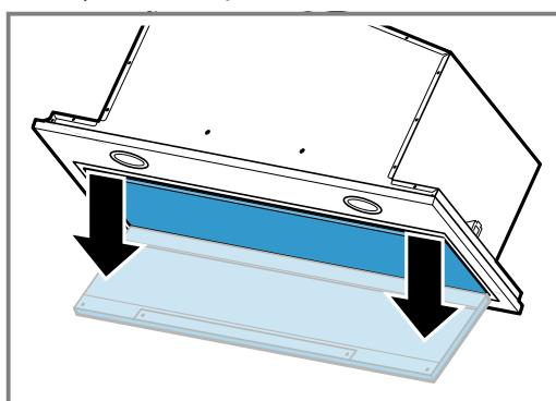
3. Demontați amortizorul balamalelor și scoateți capacul filtrului.
