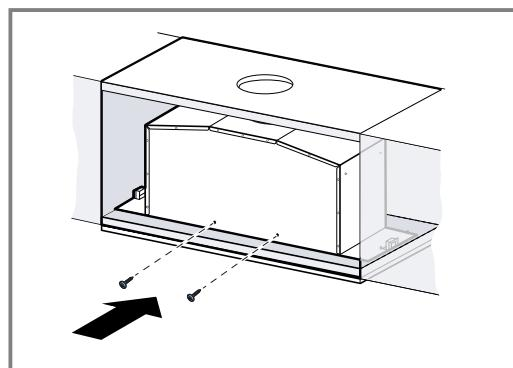
În cazul în care șuruburile nu sunt accesibile din exterior, acestea pot fi montate și din interior.
