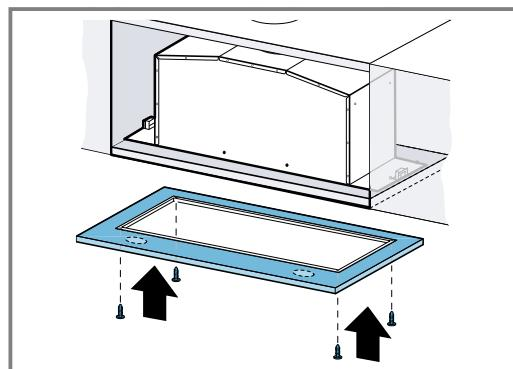
4. Fixați cu șuruburi cadrul la aparat.
