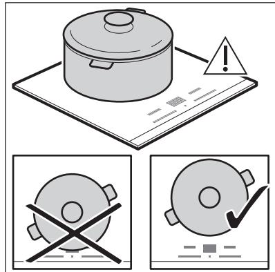
A főzőedényt a kiválasztott főzőzóna közepére helyezze. Az indukciós főzőzónák automatikusan alkalmazkodnak a főzőedény aljnák méretéhez.
