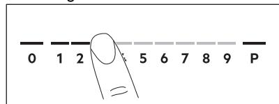
După ce ati pus un vas pe zonă de gătit și setați nivelul de căldură, acesta rămâne la fel timp de 50 de secunde după ce îndepărtați vasul. Bara de comandă clipește în a doua jumătate a respectivei perioade. Dacă puneti din nou vasul pe zona de gătit în acest timp, nivelul de căldură se reactivează. Altfel, zona de gătit se dezactivează.
