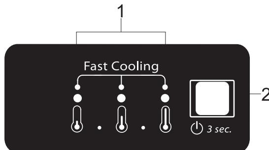
1. LED kontrolky (zobrazujú aktuálnu nastavenú teplotu funkcie Fast Cooling)
