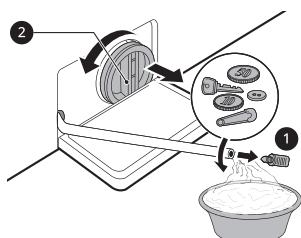
**4** Nakon čišćenja filtra odvodne pumpe pažljivo ga umetnite i pažljivo navijte pokrovni poklopac u smjeru kazaljke sata pazeći da navoj ne krene u krivo što bi moglo prouzročiti propuštanje. Ponovno umetnite čep u cijev za praznjenje i stavite je u njezin držač.
