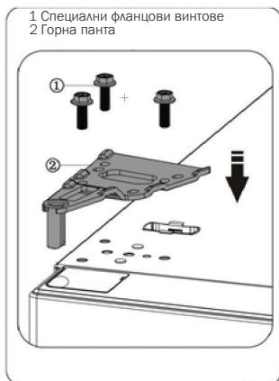
16. Фиксирайте част 1 с винт 2, вижте стъпка 2.
