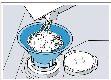
Напълнете резервоара изцяло със специална сол. Водата в резервоара се изтласква и изтича.
