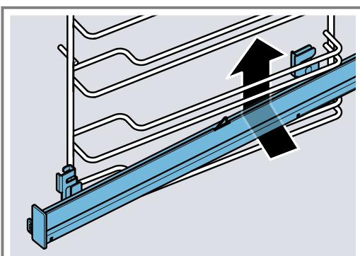
2. Прекарайте релсата надлъжно към водещите пръчки назад и избутайте двата държача върху долната пръчка. При това обхватете със задния държач **b** отвесната пръчка.
